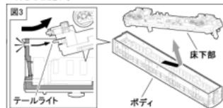
③床下部からダミーバンパーを水平に引き抜き、バンパーと付け替え、アーノルドカブラー(短)を取り付けます。
