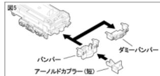
②ピンセット等を使用し、バンパーにカブラー用板バネを取り付けます。
