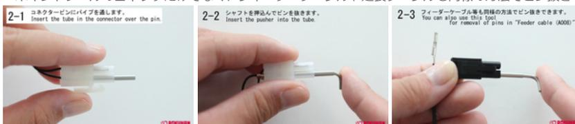
3、ピン抜き治具を使用することで、直径3.5mm程の小さな穴にケーブルを通すことができます。
