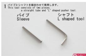
2、コネクターピンにパイプを通し、シャフトを押し込んでピンを抜きます。
